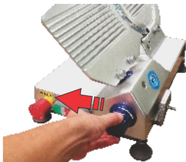
4 - Abra totalmente o regulador de corte no sentido da flecha indicativa.
